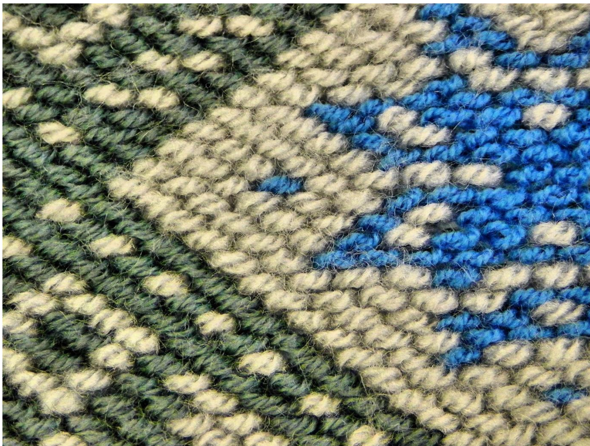
Rys. 1. Przykład dzianiny o niskiej rozciągliwości z efektem różnorodnych pętelek.
